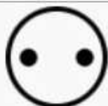
Головка под вилочный ключ (Snake-eye)
